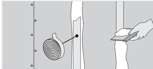
Fugen gem. DIN 18 181 mit Gewebeband und Spachtelmasse verschließen.
