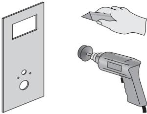
Beplankung anpassen, Ausschnitte anfertigen, Beplankung befestigen.
