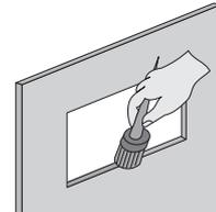
Offene Schnittkanten an den Durchbrüchen und Plattenkanten mit Tiefengrund behandeln.
