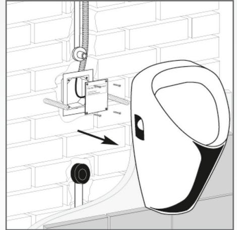
2. Burda RADAR Elektronikplatte demontieren, Steckverbindungen lösen und Stromversorgung abklemmen.
