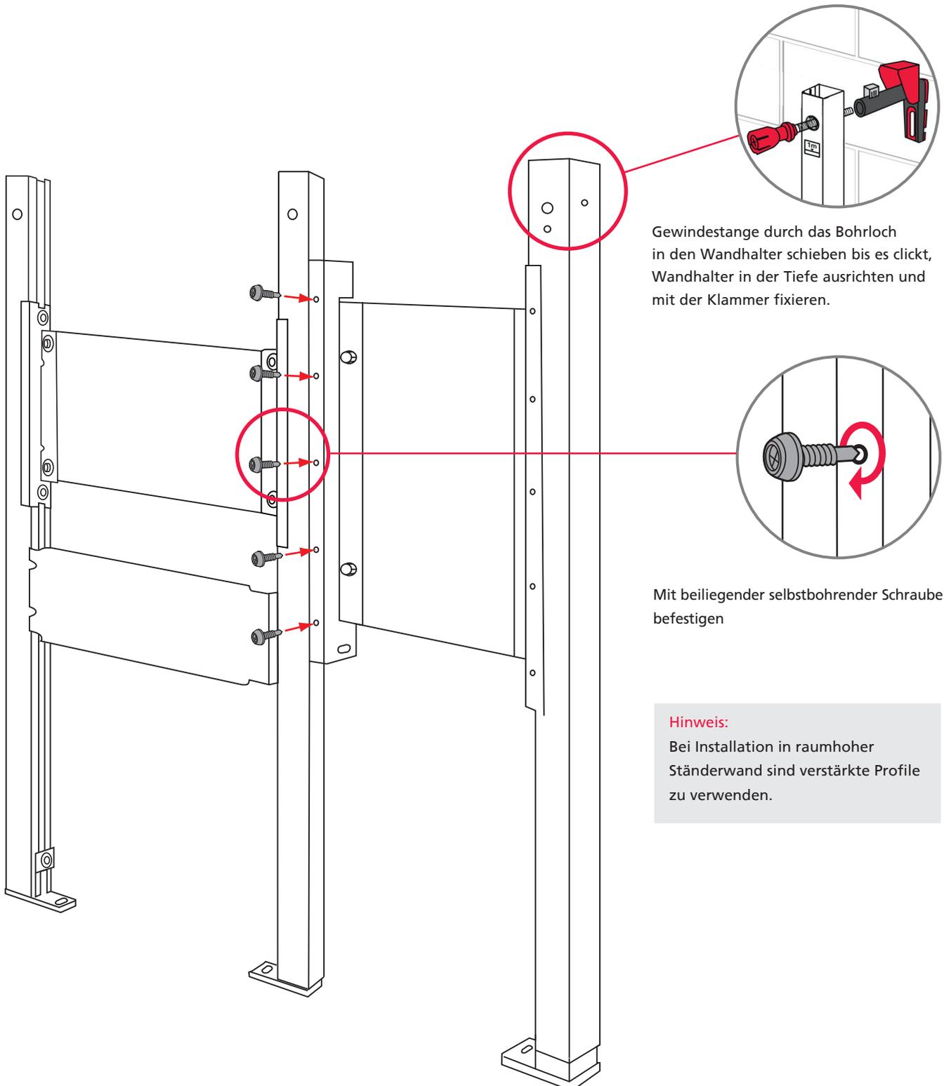
Gewindestange durch das Bohrloch in den Wandhalter schieben bis es clickt, Wandhalter in der Tiefe ausrichten und mit der Klammer fixieren.
