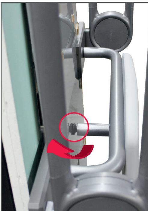
**3.** Durch drehen in der Tiefe ausrichten
