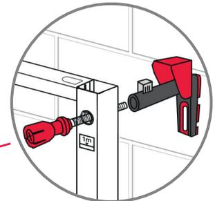
Gewindestange durch das Bohrloch in den Wandhalter schieben bis es clickt, Wandhalter in der Tiefe ausrichten und mit der Klammer fixieren.
