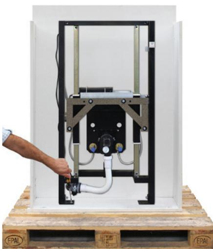
**4.** Schrauben an den Füßen lösen
