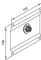
Zur Befestigung mittels Distanzschienen (677 034) zwischen 2 Sanitär-Modulen oder zwischen Modul und Zwischenträger oder nur zwischen Zwischenträger oder in einem Schachtelement .
