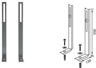
Montagehilfe für die freistehende Montage der Kombiset WC-Elemente bzw. zur Lastaufnahme der WC-Keramik. Jedoch 100 mm verlängert für barrierefreie WCs bzw. bei erhöhtem Estrich.
