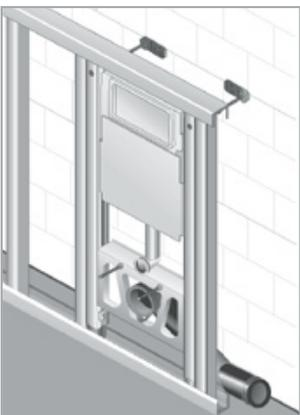
4. Fächern Sie die Ebenen, in der sich die Elemente befinden, aus. Alle 625 mm muss mit einem C-Profil ausgefächert werden bzw. ein neues Element gesetzt werden.
