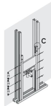
Ausgerichtete Ständerwand Elementkombination seitlich und am Fußboden verschrauben.
