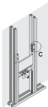
Außenkanten des Elementes bündig mit den Außenkanten der Ständerwand ausrichten und Position fixieren. (C)
