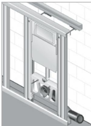
5. Jetzt bringen Sie ein weiteres U-Profil (Rückseite an die Wand) in gleicher Höhe der Oberkante des Elementes an.
