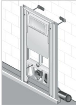
2. Links und rechts des Elementes befestigen Sie mit den selbstbohrenden Schrauben je ein C-Profil, die zusätzlich mit Popnieten unten am U-Profil verbunden werden.
