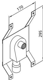
Zur Befestigung mittels Distanzschienen (677 034) zwischen 2 Sanitär-Modulen oder zwischen Modul und Zwischenträger oder nur zwischen Zwischenträger oder in einem Schachtelement .
