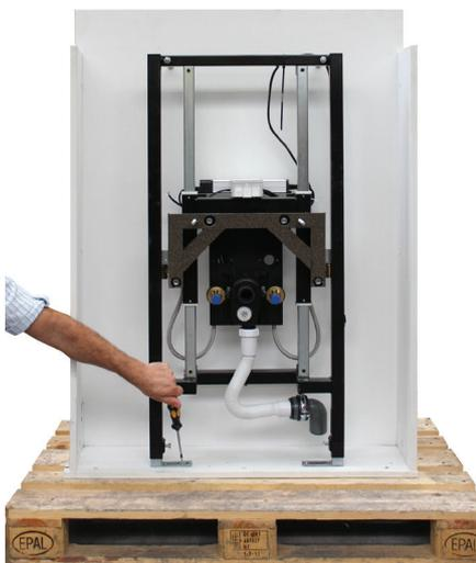
**4.** Schrauben an den Füßen lösen
