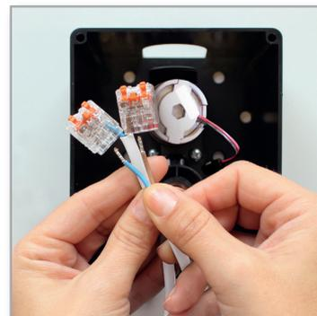
Elektronik-Box mit 230V Hausnetz verbinden, vorher Strom abschalten
