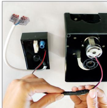
Elektronikbox mit Magnetventil verbinden
