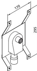
Zur Befestigung mittels Distanzschienen (677 034) zwischen 2 Sanitär-Modulen oder zwischen Modul und Zwischenträger oder nur zwischen Zwischenträger oder in einem Schachtelement .
