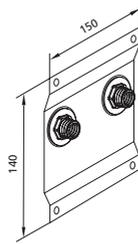
Zur Befestigung mittels Distanzschienen (677 034) zwischen 2 Sanitär-Modulen oder zwischen Modul und Zwischenträger oder nur zwischen Zwischenträger oder in einem Schachtelement .
