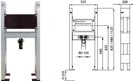
geeignet für: Trockenbau und Vorwand
