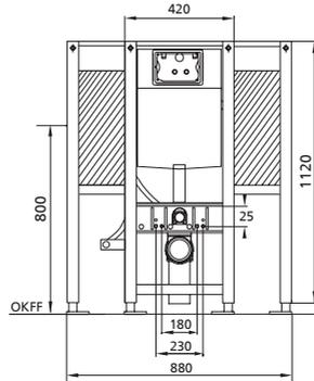
geeignet für: Trockenbau und Vorwand
