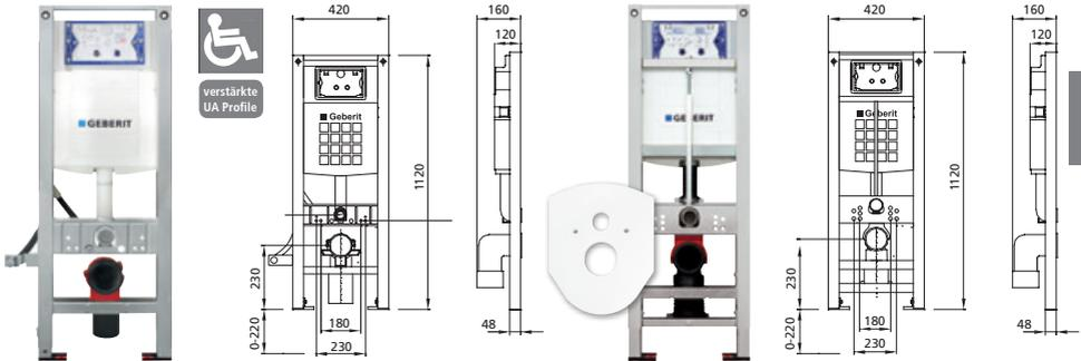
geeignet für: Trockenbau und Vorwand
