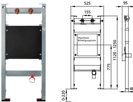
geeignet für: Trockenbau und Vorwand
