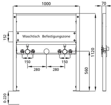
geeignet für: Trockenbau und Vorwand
