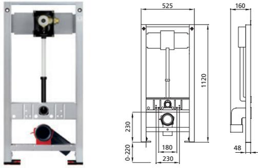
geeignet für: Trockenbau und Vorwand
