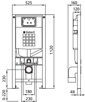
geeignet für: Trockenbau und Vorwand
