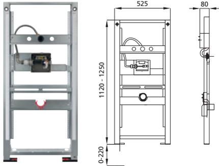
geeignet für: Trockenbau und Vorwand
