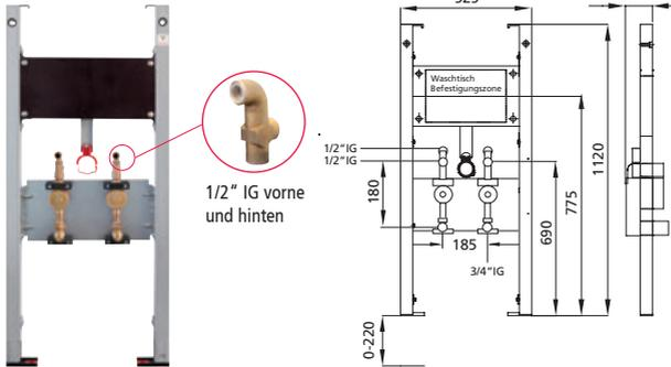
geeignet für: Trockenbau und Vorwand
