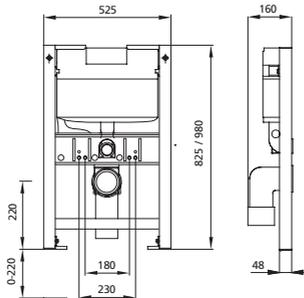
geeignet für: Trockenbau und Vorwand
