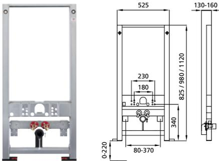
geeignet für: Trockenbau und Vorwand
