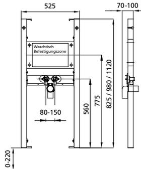
geeignet für: Trockenbau und Vorwand
