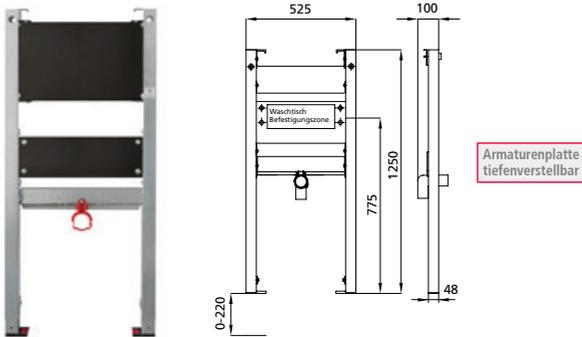
geeignet für: Trockenbau und Vorwand
