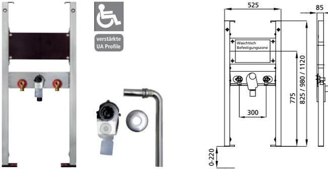
geeignet für: Trockenbau und Vorwand
