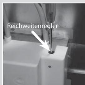
Der Reichweitenregler befindet sich unter dem weißen Aufkleber - entfernen.
