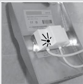
Blinkt die Diode unregelmäßig sind die Kabelverbindungen zum MV zu überprüfen. Sind diese ordnungsgemäß ange- schlossen ist das MV oder die Elektronik defekt.
