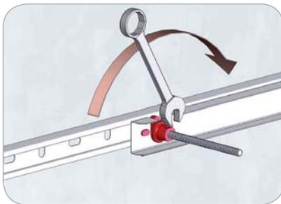
**Fußplatten einsetzen, justieren**
