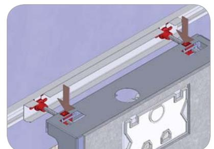
\*Nach Montage der WC-Bolzen, diese mit beiliegender 12er Mutter kontern
