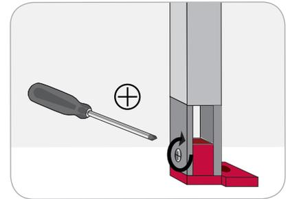
**Schraube am Außenprofil lösen**
