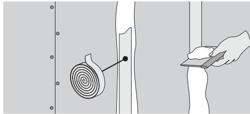
Fugen gem. DIN 18 181 mit Gewebeband
