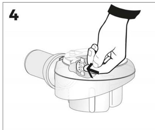
4. Verschlussstopfen flächenbündig einsetzen.
