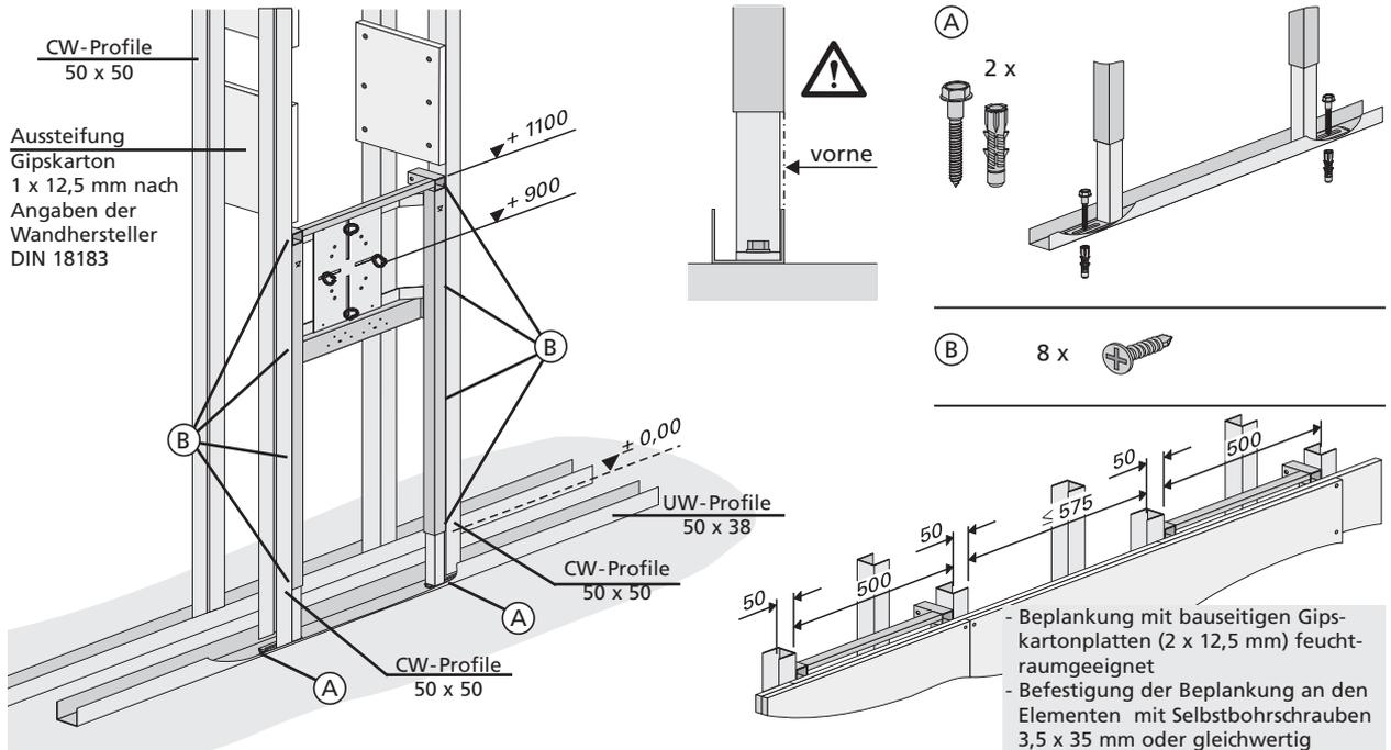
2. Vorwandssystem mit Leichtbauprofilen
