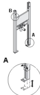
Höhenjustierung des Elementes erfolgt durch Verstellen der Füße des Elements. (A)
