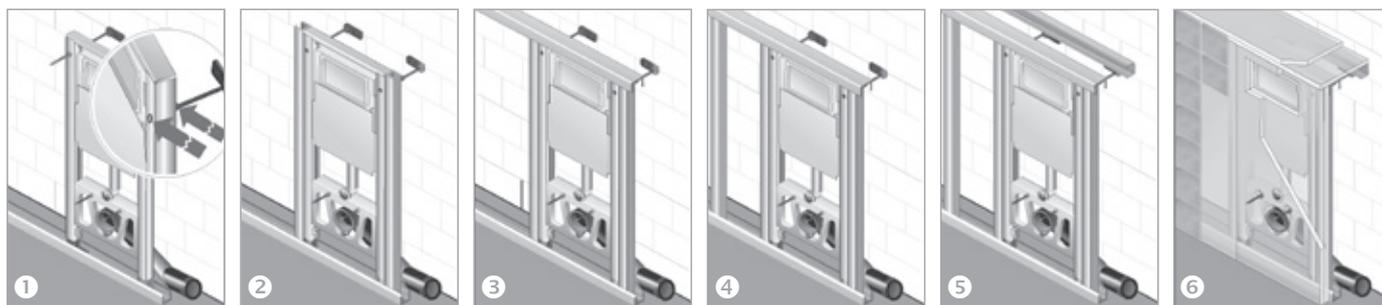
① Befestigen Sie ein U-Profil am Boden im gewünschten Abstand zur Wand und stellen Sie das BS+ Element hinein. Montieren Sie die beiden als Zubehör mitbestellten Wandwinkel an das BS+ Element und justieren Sie den Abstand des Elementes mit Hilfe der Wandwinkel. Richten Sie die Wandwinkel nach unten oder zur Seite aus. Längen Sie die Gewindestangen so ab, dass sie nicht mehr aus dem Element herausragen. Ziehen Sie die Kontermuttern an.
