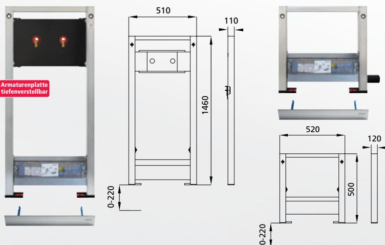
Für den Einbau in eine Ständerwand nach DIN 18183 oder in Verbindung mit Zubehörset Art.-Nr. 240012 als Einzelement in einer Vorwandinstallation verwendbar.
