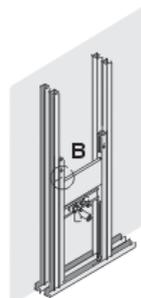
Meterriss auf der Ständerwand fluchtend mit der Markierung auf dem Element ausrichten. (B)
