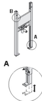
Höhenjustierung des Elementes erfolgt durch Verstellen der Füße des Elements. (A)
