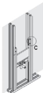
Außenkanten des Elementes bündig mit den Außenkanten der Ständerwand ausrichten und Position fixieren. (C)
