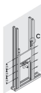
Ausgerichtete Ständerwand Elementkombination seitlich und am Fußboden verschrauben.
