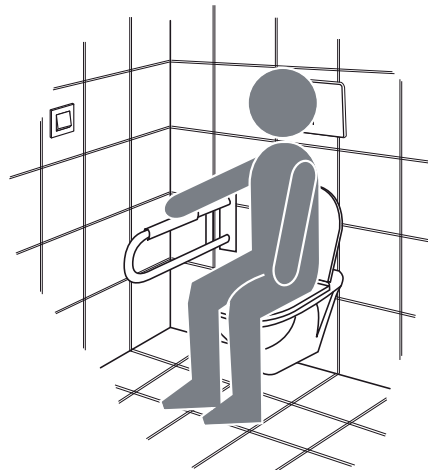
Optionale Zwischenspülung durch Anschluss von einem Stützgriff mit integriertem Taster
