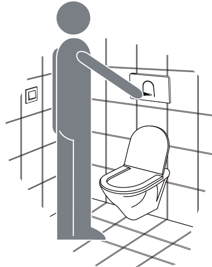
Berührungslose Spülung durch Annäherung der Hand an den Kapazitiv-Sensor
