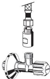
**D** Bei Mischwasserausführung Rückflussverhinderer mit Vorfilter bzw. generell Eckventil mit Vorfilter verwenden.
