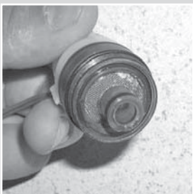
Im unteren Bereich des Ventils, wo das Wasser einströmt, befindet sich der Schmutzfilter.
