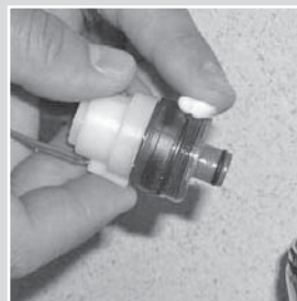
Neues bzw. gereinigtes Ventil einsetzen. Achtung! O-Ring mit Armaturenfett einstreichen.
